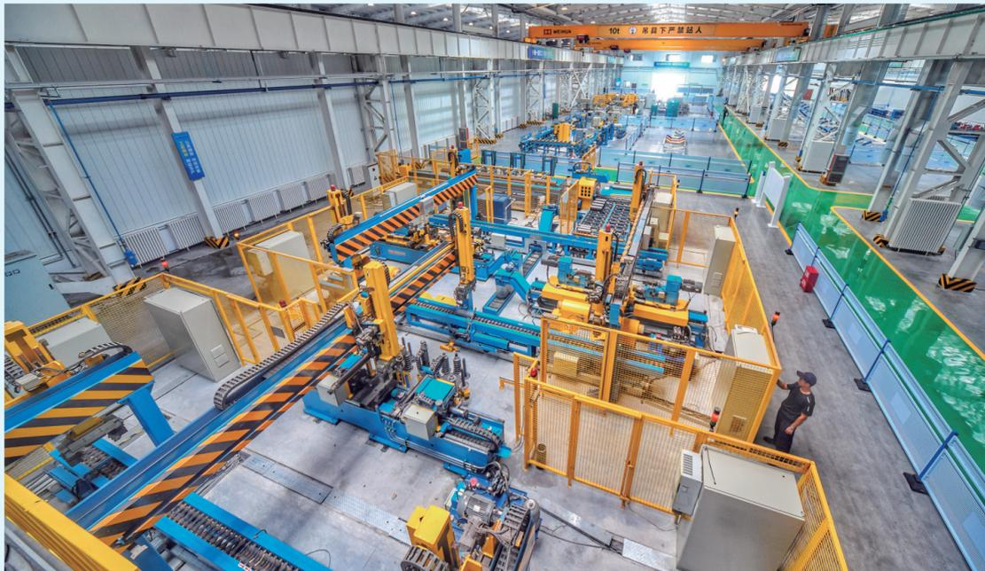
兖矿能源集团股份有限公司在邹城太平镇投资建设兖矿能源智慧制造(一期)项目,布局智能输送机制造、矿用支架电控产品制造等9个项目,打造世界一流高端煤机装备制造基地。该项目是山东省实施先进制造业突破提升的标杆项目,全部建成后,预计实现年产值150亿元,利税13亿元,提供就业岗位1500个。图为兖矿能源智慧制造项目输送机车间,主要生产托辊、辊筒产品,已成功投产。
