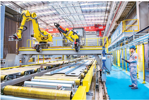
新能船业智能车间异形组立批量装焊作业中
