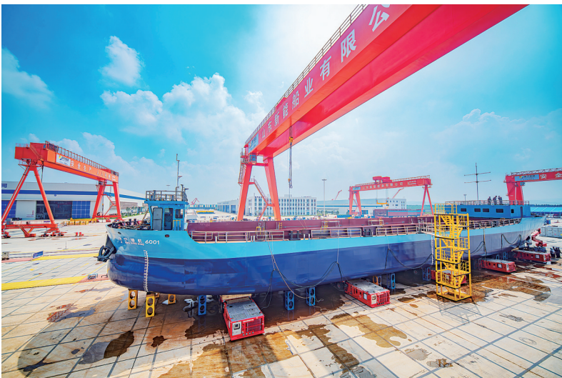
京杭运河首批新能源船舶吉水前夕模块运输车入船底
