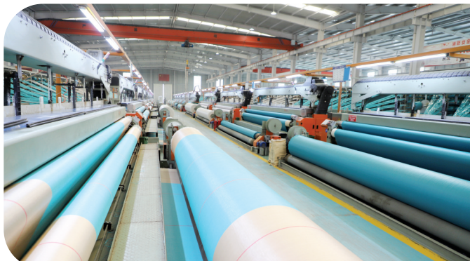
濟南政大新材料科技有限公司6米電腦編織機車間
