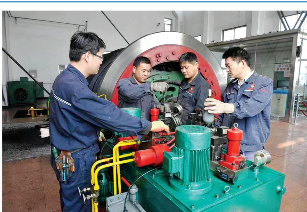
为提前做好矿井“雨季三防”工作,确保矿井安全度汛,鹿洼煤矿从强化设备管理上发力,全面排查设备安全运行状态,切实为矿井安全奠定坚实基础。图为该矿机电管理人员对液压提升设备进行检修。 ■通讯员 尹东亮 摄
