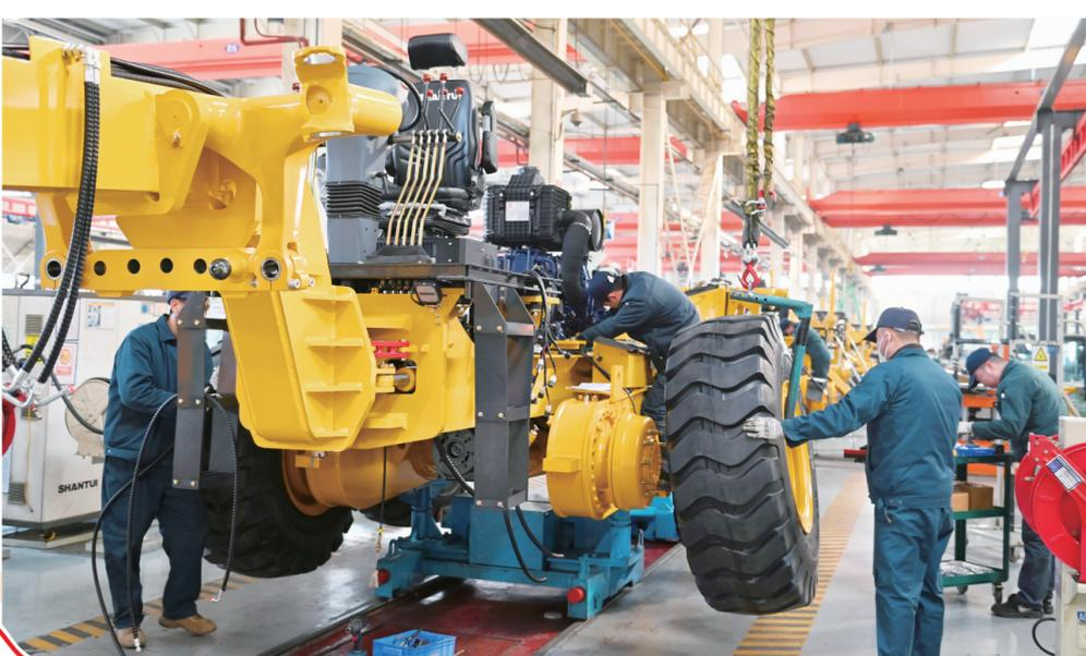
近年来,济宁高新区坚持把工业经济作为“头号工程”抓实抓好,紧盯主导产业,持续强龙头、补链条、聚集群,集中精力攻坚重点项目,持续深化领导包保、专班推进、挂图作战等工作机制,全力保障重点项目要素需求,以项目建设“加速度”不断澎湃工业经济发展“新动能”。图为济宁高新区崇文园区山推工程机械平地机装配线。
